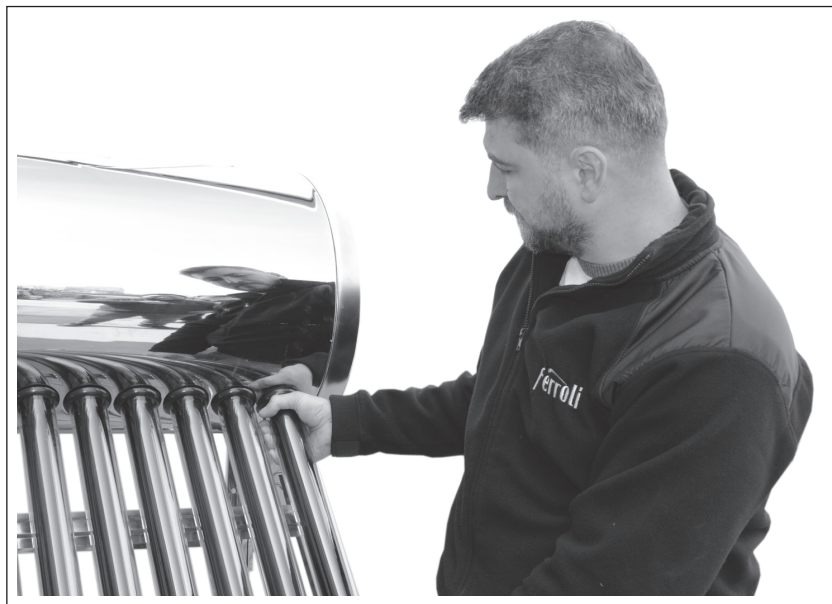
Verificați inelele antipraf pentru a vă asigura că sigilează foarte bine rezervorul
