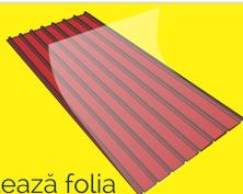
Prealabil realizării montajului, se îndepărtează folia de protecție de pe suprafața plăcilor de tablă cutată.
