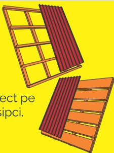
Plăcile de tablă cutată se pot monta direct pe suportul de scândură, sau pe rețea de șipci.
