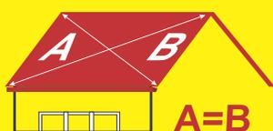
Înainte de începerea montajului, se va urmări determinarea unghiului dintre linia streășinii și cea a frontonului. În funcție de rezultatul obținut, panourile vor fi debitate pentru a obține o dispunere perpendiculară a lor pe streășină.
