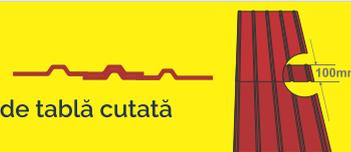
Panourile se montează cu suprapunere transversală de minim 100 milimetri. Pe lungime, panourile se montează prin suprapunerea unei singure cute.
