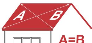
Înainte de începerea montajului, se va urmări determinarea unghiului dintre linia streaşinii şi cea a frontonului. În funcţie de rezultatul obţinut, panourile vor fi debitate pentru a obţine o dispunere perpendiculară a lor pe streaşină.
