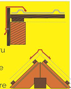
Cornier de margine – se folosește pentru închiderea laterală a acoperișului. Se fixează peste tabla cutată și scândura ce mărginește acoperișul.
