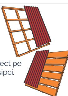
Plăcile de tablă cutată se pot monta direct pe suportul de scândură, sau pe rețea de șipci.
