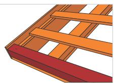
Şorţul de jgheab se montează pe patul de lemn (suport pentru sistemul de colectare), după montajul sistemului pluvial, dar înainte de fixarea foliei anti – condens.
