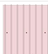
Pentru fixarea panourilor de tablă cutată, se folosesc suruburi autoforante de 4.8 X 35 milimetri, respectiv 4.8 X 20 milimetri, vopsite în aceeași culoare cu panourile și prevăzute cu garnitură de cauciuc EPDM. Consumul este de 6-7 bucăți/metru pătrat, suruburi de 4.8 X 35 milimetri (surub fixare panou în suport lemnos) și 3 - 4 bucăți/metru pătrat pentru suruburi de 4.8 X 20 milimetri (surub fixare elemente tinichigerie).
