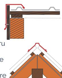
Cornier de margine - se folosește pentru închiderea laterală a acoperișului. Se fixează peste tablă cutată și scândura ce mărginește acoperișul. Coama - coamele închid zona de limitare superioară a acoperișului. Fixarea lor se realizează în zona de cutare a plăcii, din două în două cute, pentru o rigidizare sporită.
