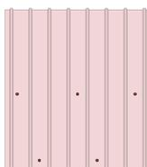
Pentru fixarea panourilor de tablă cutată, se folosesc șuruburi autoforante de 4,8 X 35 milimetri, respectiv 4,8 X 20 milimetri, vopsite în aceeași culoare cu panourile și prevăzute cu garnitură de cauciuc EPDM. Consumul este de 6-7 bucăți/metru pătrat, șuruburi de 4,8 X 35 milimetri (șurub fixare panou în suport lemnos) și 3 - 4 bucăți/metru pătrat pentru șuruburi de 4,8 X 20 milimetri (șurub fixare elemente tinichigerie).
