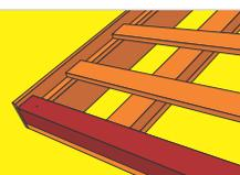
Șorțul de jgheab se montează pe patul de lemn (suport pentru sistemul de colectare), după montajul sistemului pluvial, dar înainte de fixarea foliei anti - condens.
